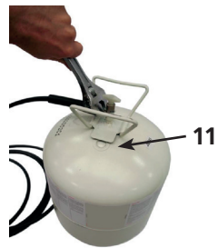
10 Aansluiting lijmslang aan drukvat 11 Ronde "zwakke" plek. Inslaan zodat de restant lijmresten kan uitharden
